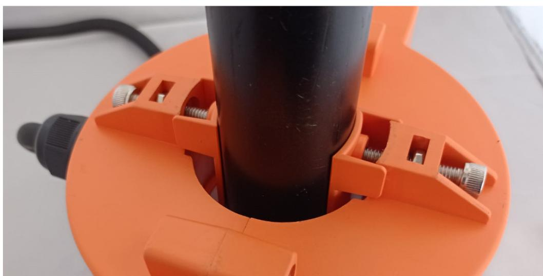
**Figura 3-19 : Sujeción de transformadores de corriente**
