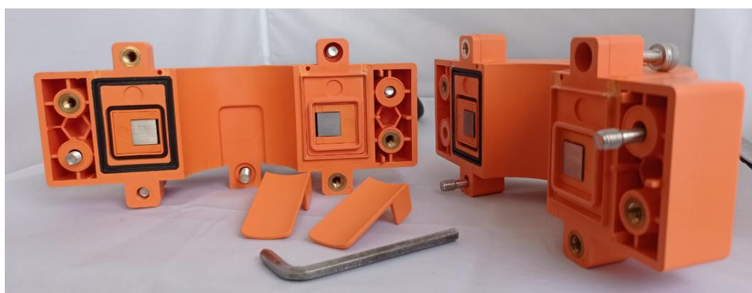
**Figura 3-17 : Apertura de transformadores de corriente**
