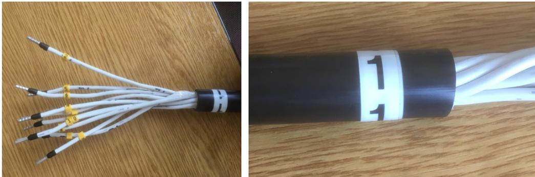
**Figura 3-10 : Cables de Control para Celdas**
